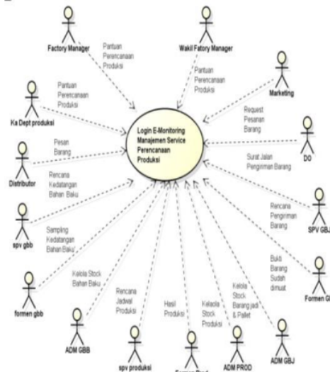
Gambar 9. Uses Case Diagram Login pengguna ke Sistem E-Monitoring Manajemen Service Perencanaan Produksi
